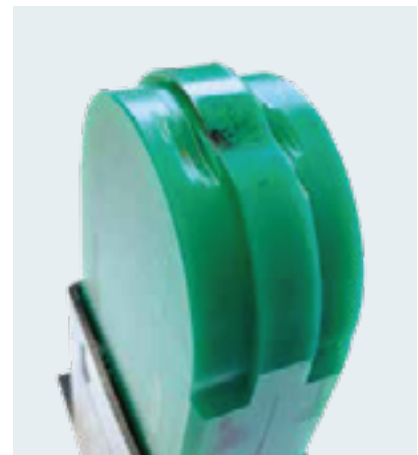
Mögliches Verschleißbild durch Überlastung der Spann-Box®
